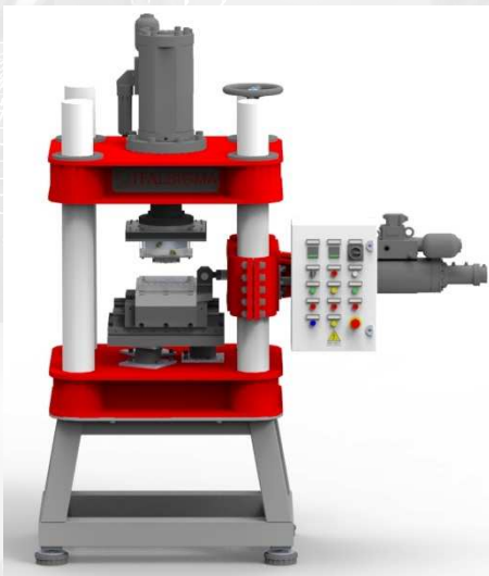
Macchina Biassiale: Carico verticale 500 kN Carico orizzontale 100 kN Corsa vert. e orizz. 100 mm.
