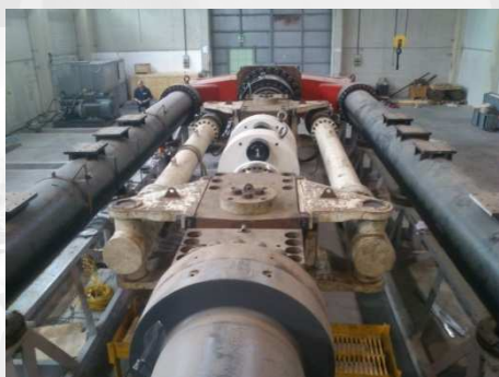
Impianto Biassiale per Prove di Trazione (25 MN) e Flessione (1 MN/m)
