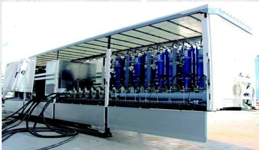
Laboratorio Mobile per alimentazione oleodinamica fino a 6.000 l/min, 350 bar
