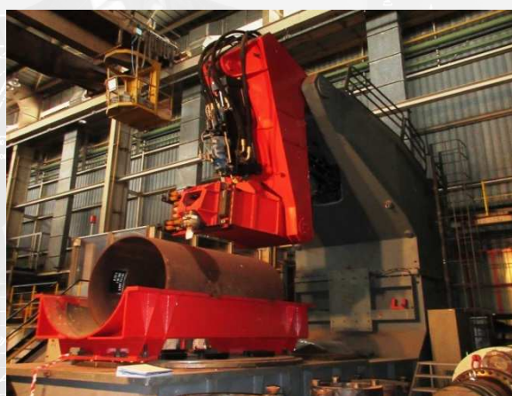
Impianto per Prove di Danneggiamento su tubazioni "Full Scale"
