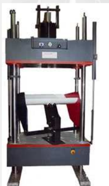
Telaio di carico per Automotive: Portata 500 kN Corsa 2.000 mm.
